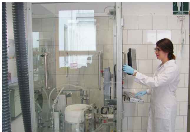
Napylarka „spin coater” do tworzenia cienkich warstw materiałów węglowych i polimerów
