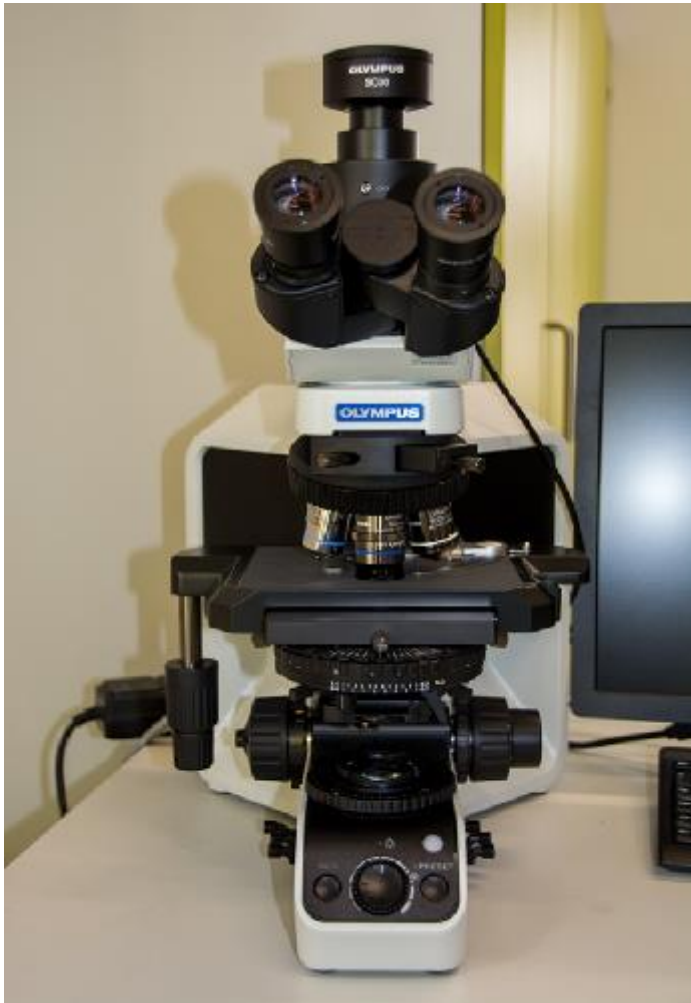
Fot. 12. Mikroskop badawczy z kontrastem Nomarskiego (fot. M. Karpowicz) Fot. 12. Differential interference contrast (DIC) microscopy (fot. M. Karpowicz)
